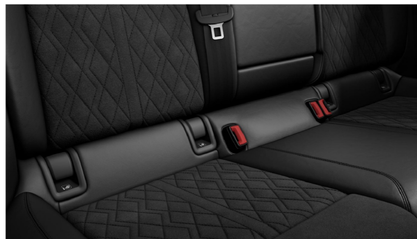
Mocowanie ISOFIX z przodu, top tether i i-Size dla skrajnych siedzeń z tyłu ⓘ
